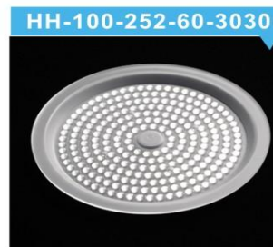
规格/ Specification: 270×16.98mm 角度/ lens angle: 60° 灯芯数/Wick: 252×1=252 材料/Material: PC
